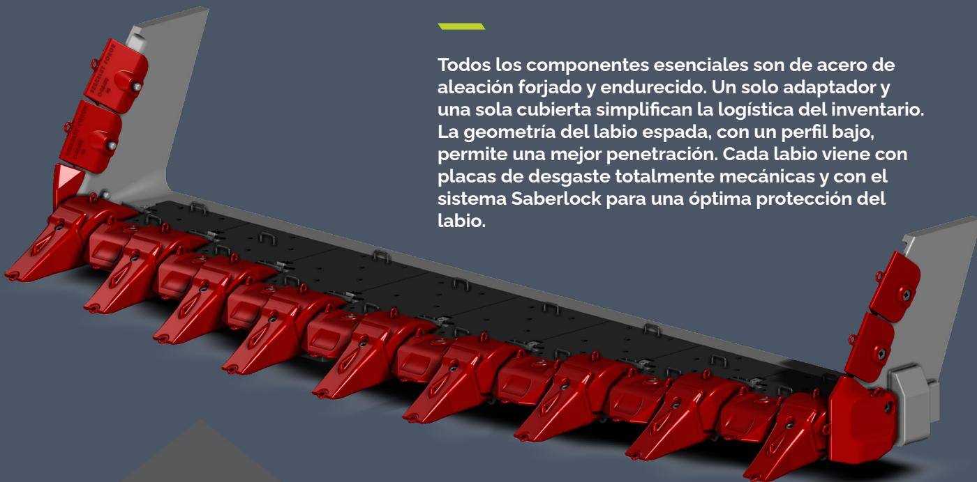
**Todos los componentes esenciales son de acero de aleación forjado y endurecido. Un solo adaptador y una sola cubierta simplifican la logística del inventario. La geometría del labio espada, con un perfil bajo, permite una mejor penetración. Cada labio viene con placas de desgaste totalmente mecánicas y con el sistema Saberlock para una óptima protección del labio.**
